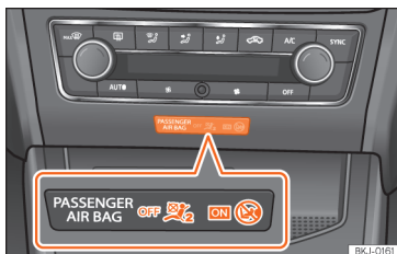
Слика 26 Средишен дел на инструментната табла: Контролна сијаличка за исклучено предно воздушно перниче за совозач.
