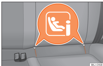
Слика 34 ISOFIX окца за прицврстување/iSize.
