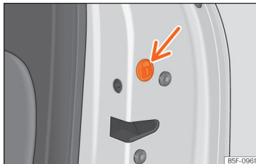
Слика 7 Блокирање на вратата во итен случај.
