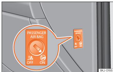
Слика 25 Прекинувач за воздушното перниче за совозачот.
