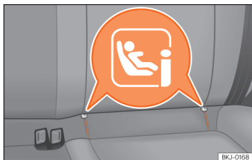
Слика 36 ИСОФИКС окца за прицврстување/iSize.
